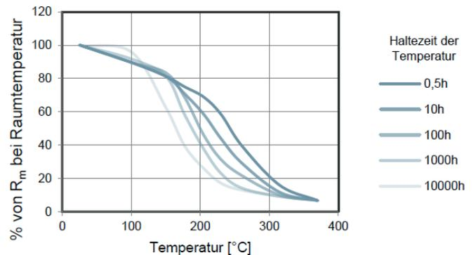
$R_{p0,2}$  bei Raumtemperatur nach erhöhter Temperatur
