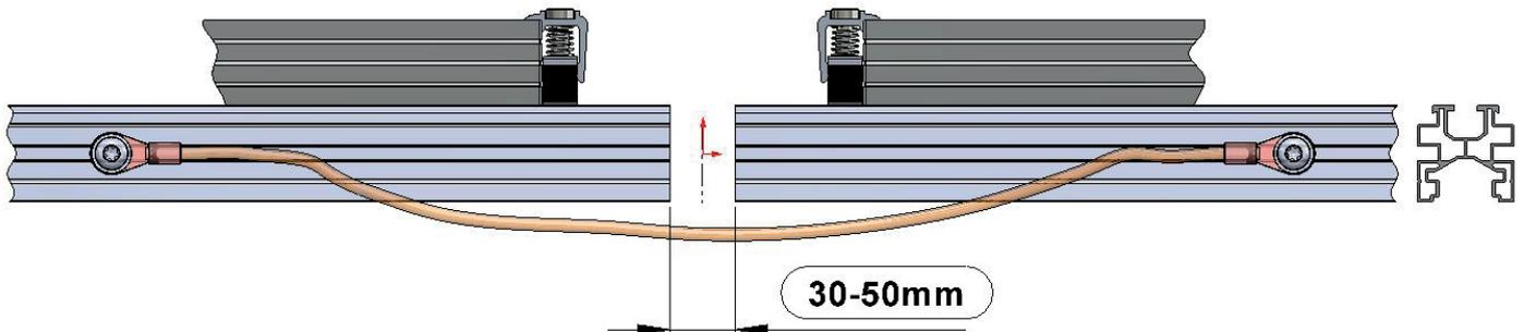
Wichtig: der Blitzschutz muss gewährleistet sein. Bei einseitig geschraubten Profilverbindern (Variante 1 oder Variante 2) muss eine blitzstromfähige Bandschleife montiert werden.
