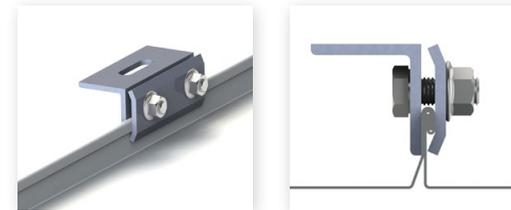
Rundfalz-Klemme auf den Falz setzen, ausrichten und die seitlichen Schrauben mit **15 Nm** Drehmoment festziehen.
