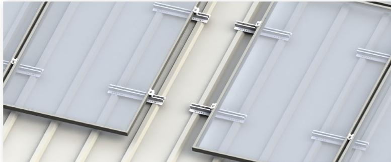
**Option:** Sollte der Klemmbereich des Moduls und der Abstand der Hochsicke es zulassen, kann die Trapezblechbrücke versetzt auf der Hochsicke zur thermischen Trennung befestigt werden. Achten Sie bei größeren Anlagen trotzdem auf genügend Wartungsgänge.
