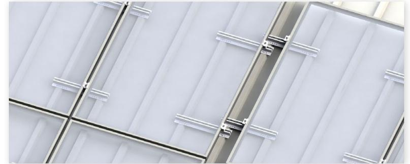
Planen Sie grundsätzlich Wartungsgänge bei größeren Anlagen in horizontaler und vertikaler Richtung ein.
