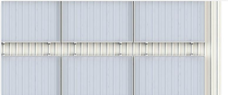
Die thermische Trennung, der Abstand zwischen den Kurzschielen nach 12 m in vertikaler Richtung, muss mind. 20 mm betragen (auf derselben Hochsicke).
